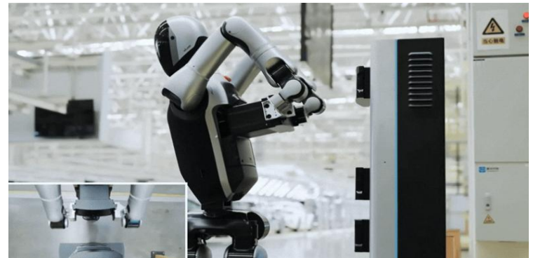
UBTech - 스스로 배터리를 교체할 수 있는 Walker S2 모델
