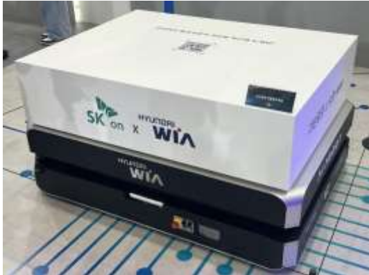
자료: 키움증권 리서치 주: SK온의 하이니켈 NCM 배터리 탑재, 1회 충전 시 최대 8시간 운행 가능. 1.5t형 AMR로 무게는 500kg
