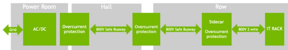
그림 2. NVIDIA 800V HVDC 아키텍처는 에너지 변환을 최소화
